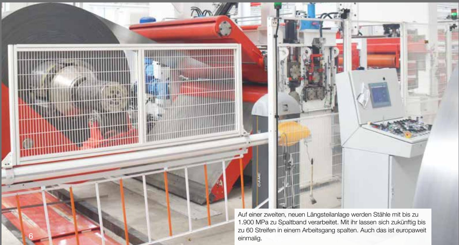
Auf einer zweiten, neuen Längsteilanlage werden Stähle mit bis zu 1.900 MPa zu Spaltband verarbeitet. Mit ihr lassen sich zukünftig bis zu 60 Streifen in einem Arbeitsgang spalten. Auch das ist europaweit einmalig.
